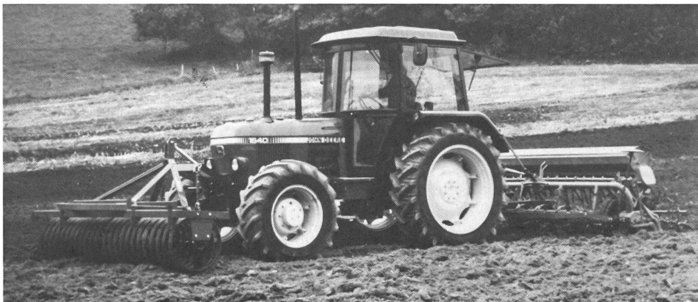
1: Le rouleau spiral frontal est à la mode, globalement son action sur le sol se rapproche de celle des rouleaux squelettes. Il est néanmoins plus robuste et moins cher que le système plus sophistiqué à pneu. Son utilisation en sols argileux n'est pas toujours évidente.
