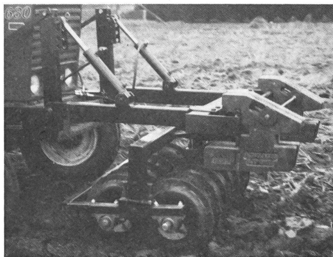
4: «Tasse-avant» composé de deux packers, le tout étant supporté par deux vérins. Avantage de ce système, il casserait mieux les mottes. Système nouveau, il mérite néanmoins d'être suivi sur le terrain avant de lui apporter un jugement plus complet.
