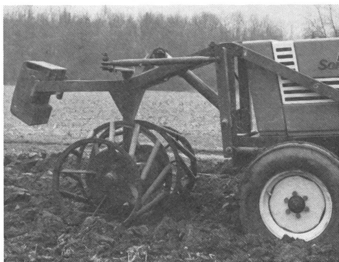
3: Rouleau squelette avec barillets inclinés pour favoriser le débouillage. Ce système peut aussi être monté avec des pneumatiques d'avion.
