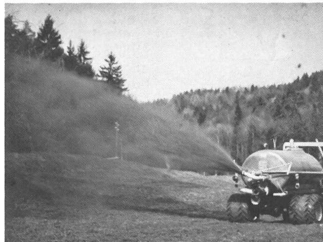
Fig. 6: Sur des terrains non carrossables, la citerne avec pompe permet de puriner, pour autant que la longueur de jet soit suffisante.
