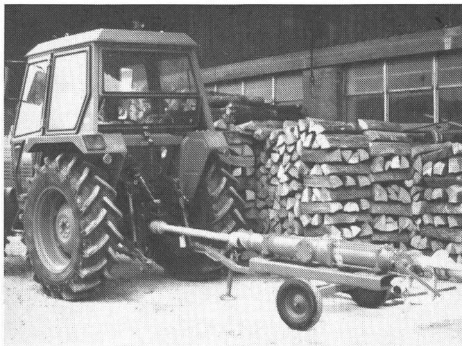
Fig. 2: On entraîne souvent les pompes à haute performance par la prise de force afin de garantir une puissance suffisante.
