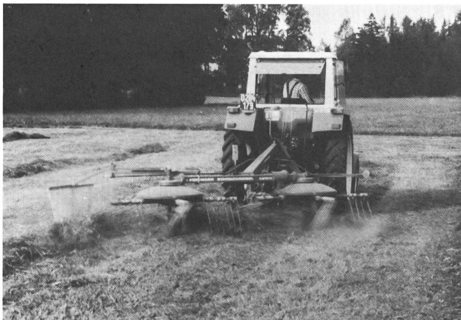
Fig. 1: Des machines réglées vers le bas évitent évidemment des pertes, mais il faut alors accepter davantage de traces de salissures.
