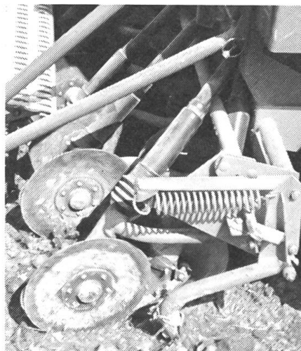
Pour traiter un lit de semences envahi de résidus de plantes, on trouve des socs à disques roulants.
