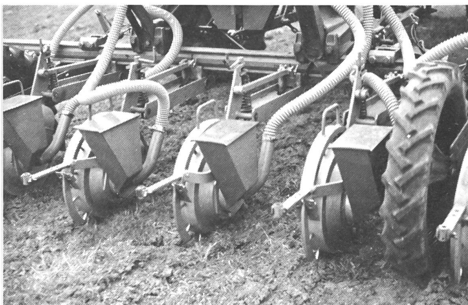
Sans charrue, mais avec une technique de semis adaptée, on réussit à cultiver avec succès la betterave difficile, ce qui a été démontré par un essai à large échelle avec un semoir à étampe.
