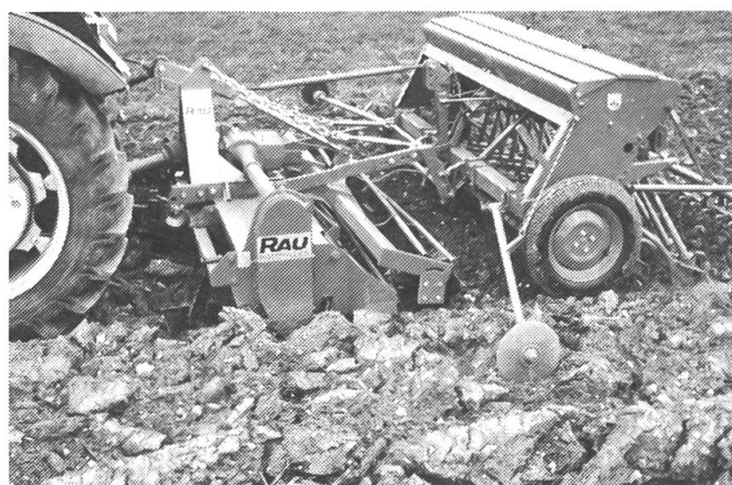
Avec une combinaison de machines «rotor à dents et semoir», ce champ peut être semé en une opération après le sillon de la charrue.
