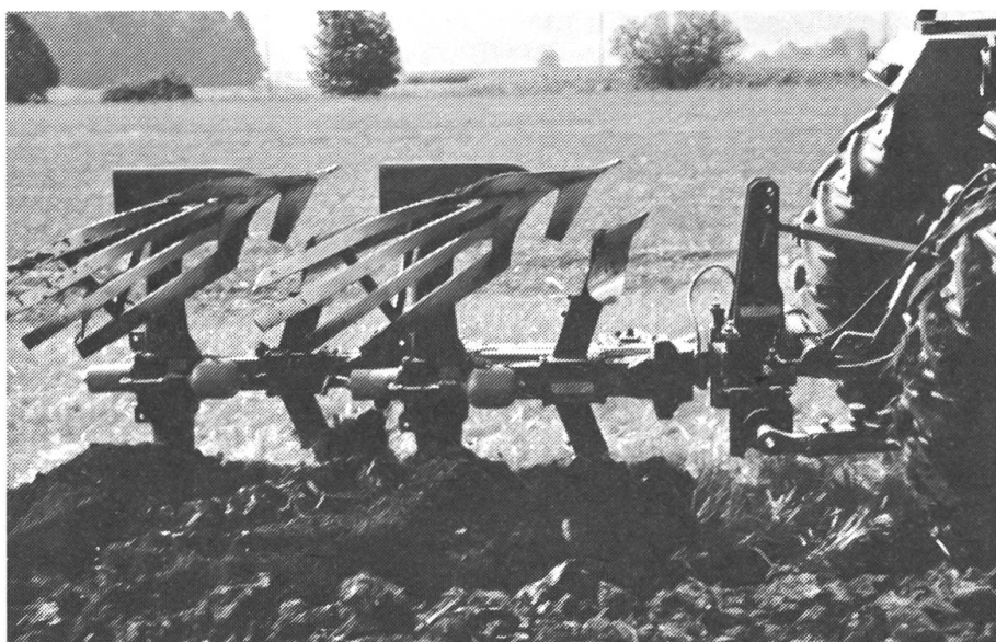
Les versoirs universels en bandes peuvent être mis en œuvre sur chaque sol. Il ne faut néanmoins pas attendre des avantages notables par rapport aux versoirs standards meilleur marché.
