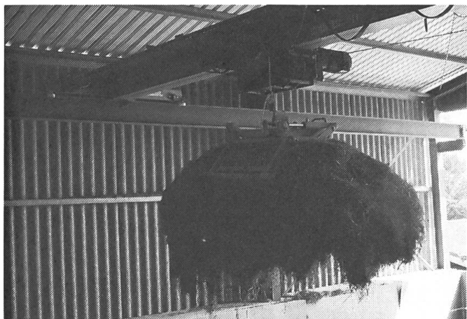
Fig. 2: Remplissage à l'aide d'un déchargeur à griffe. Il faut veiller à remplir de façon consciencieuse. Une répartition complémentaire, manuelle est nécessaire.
