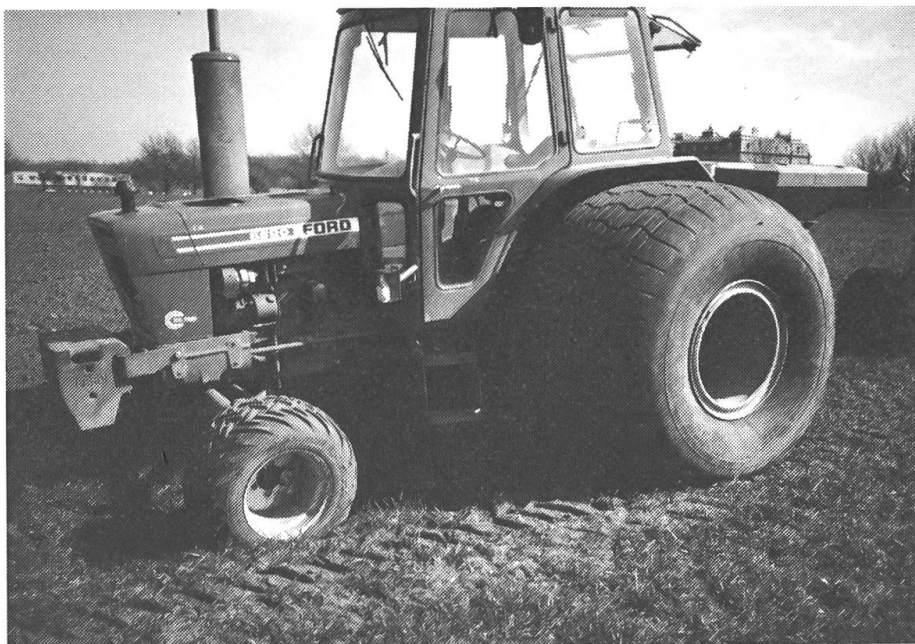
Par un choix de pneumatiques à grand volume, on peut réduire la pression des pneus et diminuer le tassement dans la trace.
