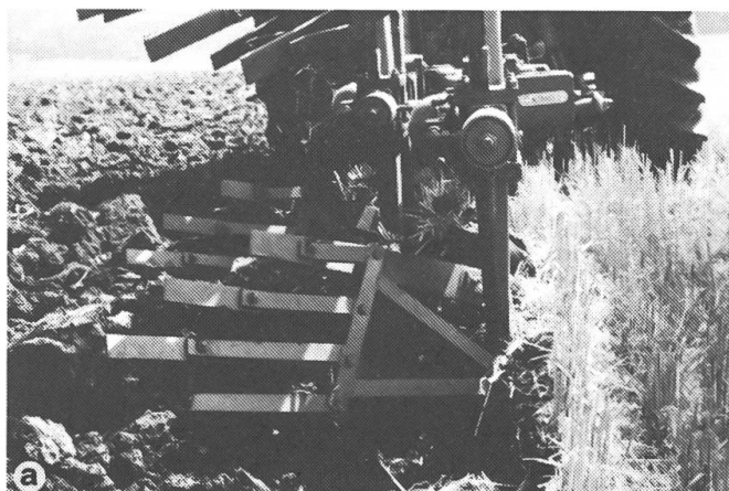
Abb. 5: La pression sur les pièces individuelles du versoir à claire-voie (a) et à fentes (b) est inégale et supérieure à celle du versoir standard.
