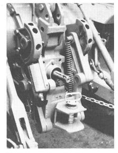
Fig. 7: Le système SEMAG avec crochet d'attelage réglable au moyen d'un parallèlogramme raccourcit la distance entre le milieu de l'axe arrière et le crochet d'attelage (moins de risque de cabrage du tracteur)
