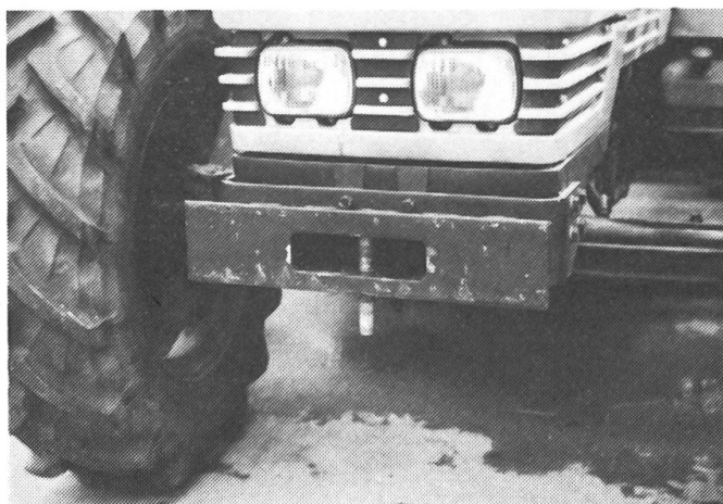
Fig. 11 et 12: Les mécanismes de traction et de poussée ayant des ouvertures trop étroites endommagent le timon de la remorque lorsque l'angle est trop grand.
