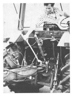
Fig. 8: Malgré l'allongement des chevilles d'arrêt, la manœuvre de la chape est difficile.
