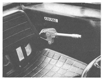
Fig. 10: Le levier de télécommande doit être assuré contre l'actionnement involontaire et doit être bien étique-
