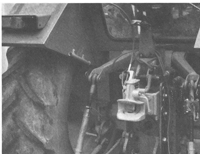
Fig. 9: Le crochet d'attelage automatique avec télécommande rend possible l'accrochage et le décrochage depuis le siège du conducteur, ceci aussi avec des cabines pour conducteurs fermées.
