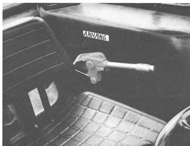
Fig. 10: Le levier de télécommande doit être assuré contre l'actionnement involontaire et doit être bien étiqueté.
