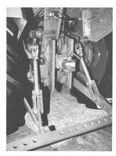
Fig. 3: Crochet d'attelage rapidement réglable Fendt.
