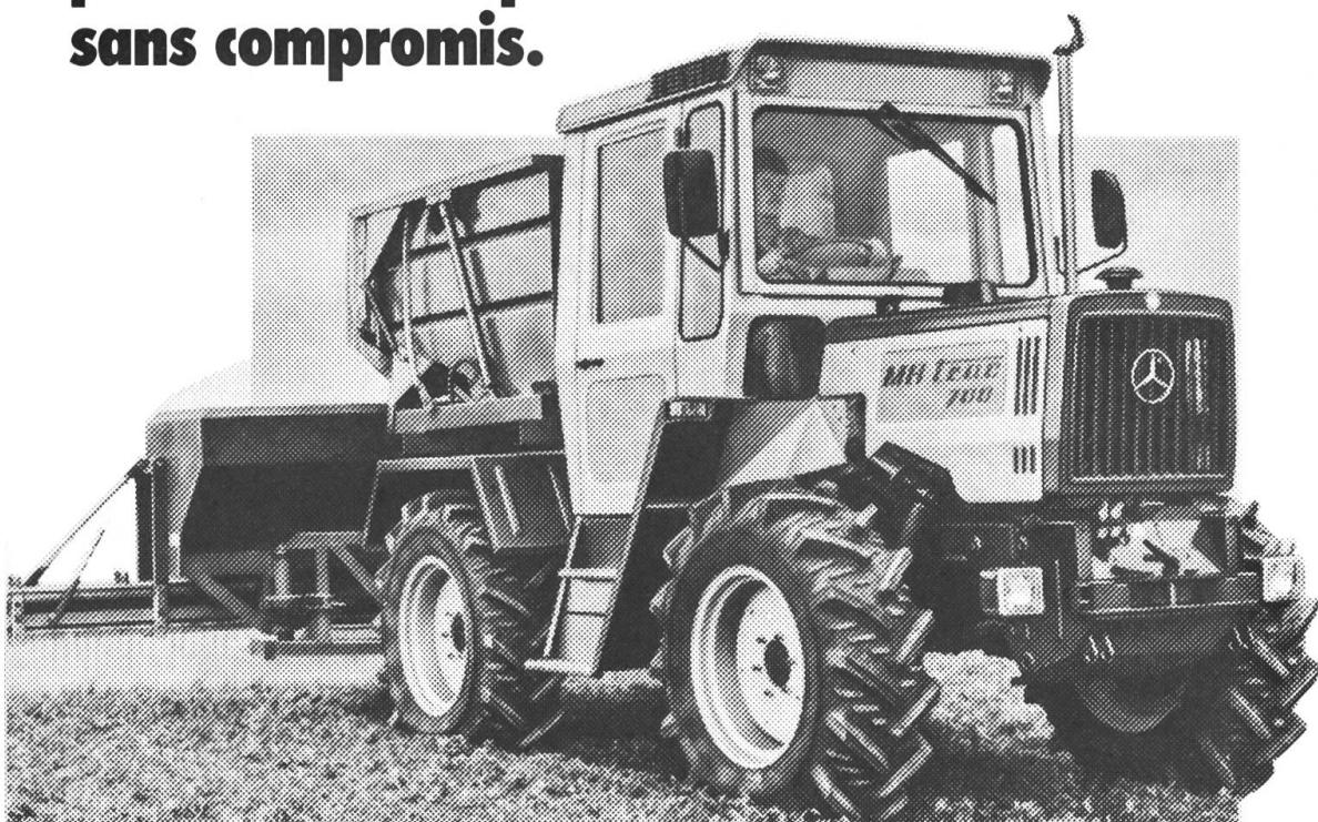
Lors des travaux intensifs de printemps les qualités d'un tracteur agricole sont décisives. C'est pourquoi le MB-trac est équipé d'un authentique entraînement tous terrains à deux essieux de même puissance, avec un verrouillage intégral du différentiel sur les
