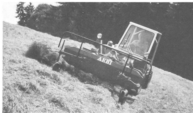
3 Une faucheuse à 2 essieux doit pouvoir être mise en œuvre de manière polyvalente. Dans les pentes raides et sur terrain accidenté, on ne peut utiliser pour l'andainage que le râteau-faneur. Le giro-andaineur n'est utilisable que jusqu'à la limite de mise en œuvre du tracteur.
