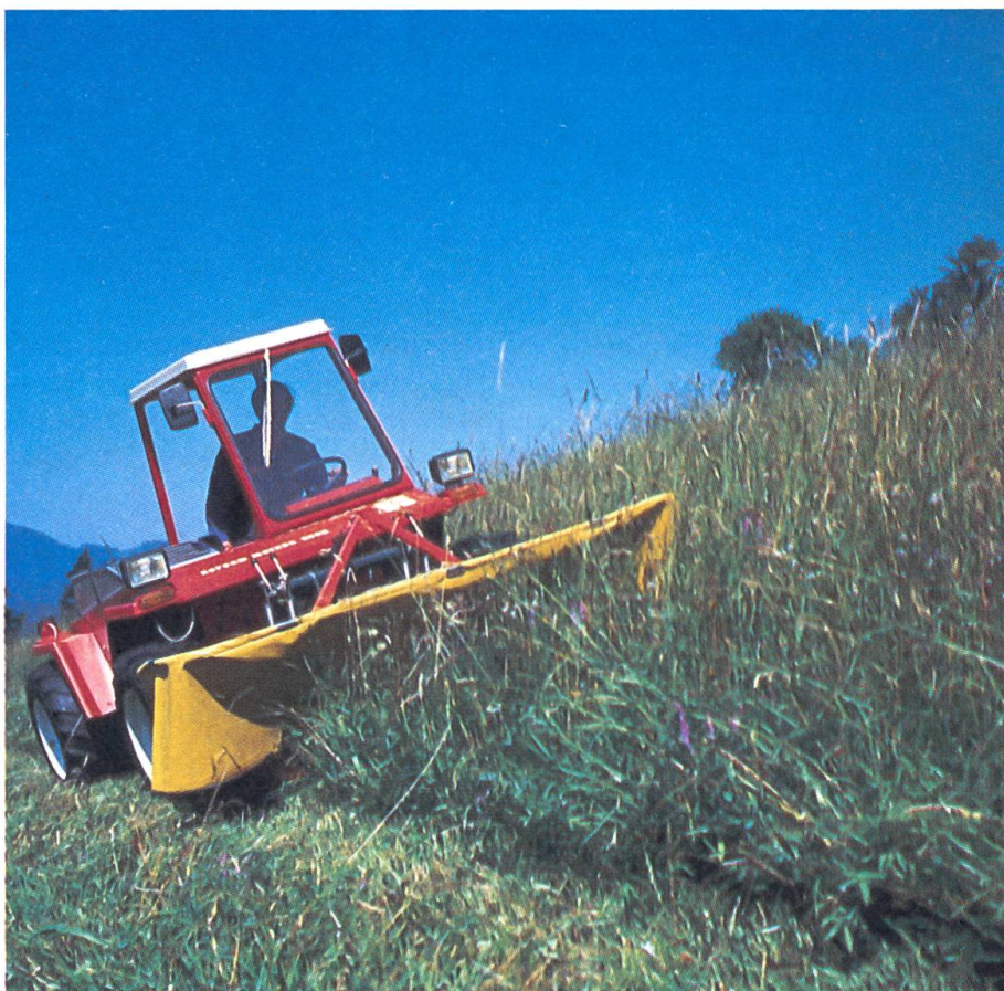
1 Le choix du dispositif de coupe est prioritaire lors de l'acquisition d'une faucheuse à 2 essieux.
