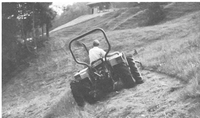
2 Les petits tracteurs modifiés sont également très appropriés à la pente s'ils sont équipés à l'avant de pneus Terra et à l'arrière de roues doubles. La barre de coupe doit être plus large d'au moins 20 cm que la largeur totale s'il s'agit de ne pas écraser trop de fourrage en débutant la fauche dans la courbe de niveau.
