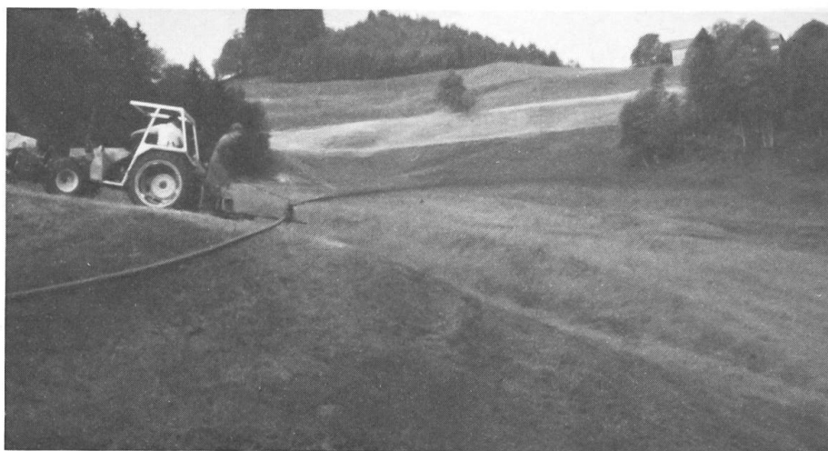
4 La faucheuse à 2 essieux n'est aujourd'hui plus réservée uniquement à la récolte du fourrage. D'autres possibilités de mise en œuvre sont les petits transports avec chargeuse à plate-forme ou arroseurs-asperseurs de lisier.
