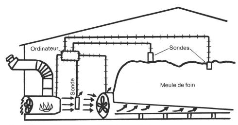
Fig. 1: Séchage en grange, commandé par ordinateur.
