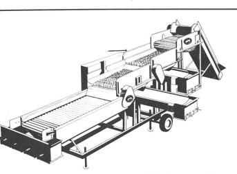
Fig. 2: Trieur-calibreur avec deux bandes rotatives de mailles de criblage pour la préparation de trois fractions de tubercules (TONG, GB).
