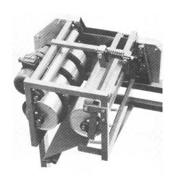
Fig. 3: Agrégat de calibrage avec rouleaux en spirale (KUSTER + VO-GEL, CH). La distance variable entre le rouleau en spirale et le rouleau lisse constitue la fente de tri. Une paire de rouleaux est nécessaire pour chaque fraction.
