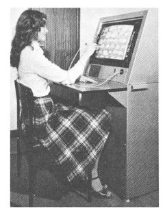
b) Les tubercules à trier, peuvent être séparés et marqués électroniquement sur un ou plusieurs écrans en couleur (télésélecteur).
