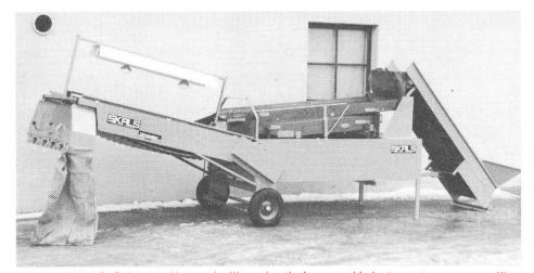
Fig. 9: SKALS SK 613: Une voie libre destinée aux déchets se trouve au milieu de la table de contrôle.
