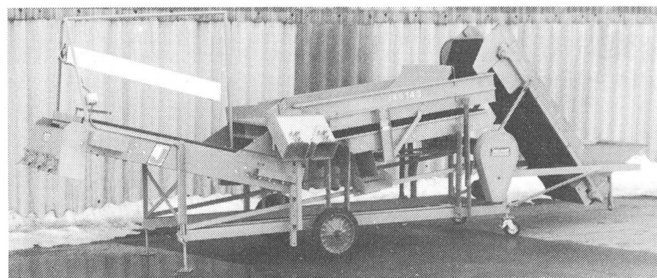
Fig. 8: JABELMANN JKS 143: Les tubercules des cribles inférieurs parviennent sur les deux voies de tri. Les surplus du crible supérieur est reçu par une bouche d'ensachage installée sur le côté gauche ou sur celui de droite.
