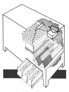
Fig. 4: Système de tri et de calibrage électronique (LOCTRONIC, GB).
