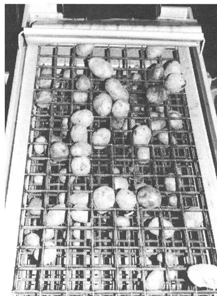
Fig. 16: Avec les deux machines à cribles oscillants, on peut la plupart du temps libérer les tubercules coincés sans les toucher, simplement en augmentant le nombre de tours (JABELMANN). Les cribles revêtus de caoutchouc ou de plastique ménagent les tubercules pendant le transport, mais provoquent cependant une tendance au bourrage plus forte.
