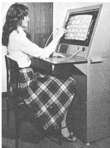
b) Les tubercules à trier, peuvent être séparés et marqués électroniquement sur un ou plusieurs écrans en couleur (télésélecteur).
