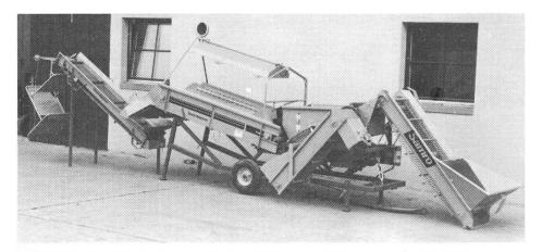
Fig. 7: SAMRO KS 80. Les tubercules sur le crible supérieur peuvent être dirigés soit sur la voie de tri du milieu soit sur celle du côté droit. Dans ce dernier cas, la voie de gauche non approvisionnée est destinée au dépôt des tubercules de rebut. Cette variante ne convient pas à des performances rapides, car il se forme un bouchon à la sortie du crible supérieur.
