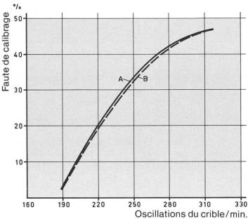
Fig. 13: Système à secousses par intervalles (SKALS): Influence de la fréquence des cribles (oscillations du crible/ minute) et de la performance de débit sur l'exactitude de calibrage).
