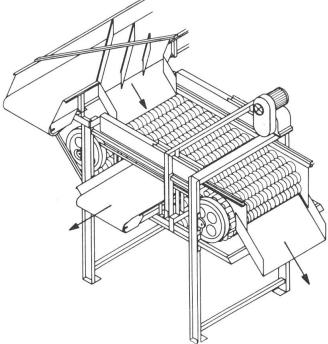
Fig. 1: Système de calibrage avec rouleaux profilés rotatifs. La forme spéciale des rouleaux permet un calibrage au carré. Avec un agrégat, plusieurs fractions de calibrage peuvent être établies en même temps (BLASER CH, machine à l'étude pour les exploitations agricoles).
