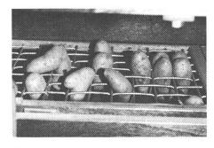
Fig. 15: Avec le système à secousses par intervalles, seuls les grands cribles avec des tubercules difformes sont sujets au bourrage (COMPAS).
