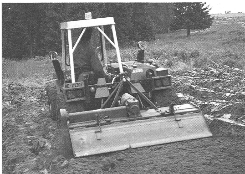
5 Faucheuse à deux essieux avec fraise. Des machines de ce type ne peuvent être utilisées que jusqu'à des pentes de 70%.
