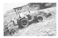
Fig. 6: Faucheuse à deux essieux avec barre de coupe (poids frontal) et faneuse à toupies 3-points, légèrement soulevés.
