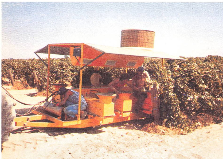
La place de travail est ombragée et dispose d'une ventilation (installation sur le toit).
