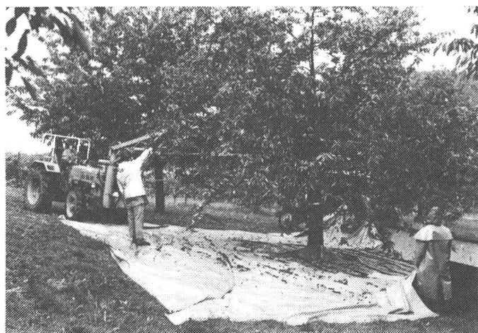
3 Le secoueur danois Schaumann lors de la récolte de cerises à distiller. Les arbres sont secoués branche par branche.
