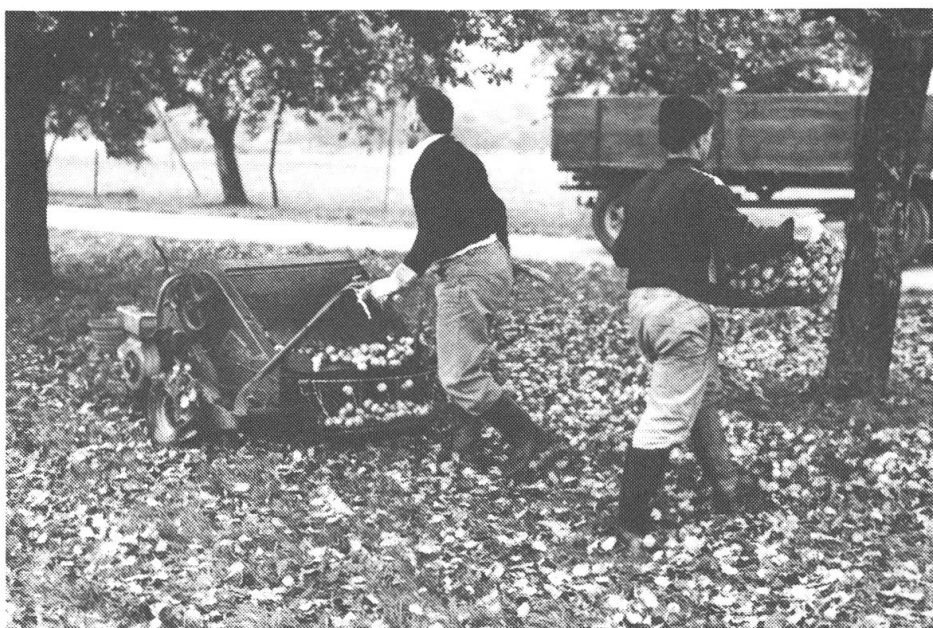
2 Dans les vergers hautes tiges de fruits à cidre, la ramasseuse française «Super» (Cacquevel) a fait ses preuves. Il s'agit là de mécanisation partielle. Les fruits sont ramassés par des rouleaux munis de lamelles en caoutchouc et conduits dans une corbeille à grillages d'une capacité d'env. 30 kg. La corbeille doit être versée manuellement dans une remorque ou une autochargeuse.
