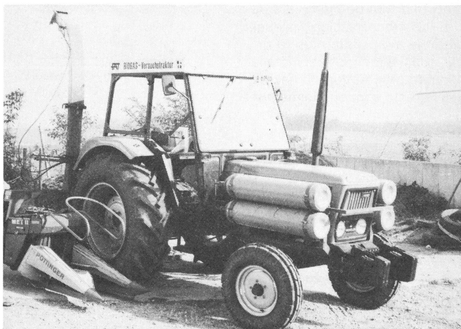
Fig. 1: Le tracteur expérimental transformé pour les fonctionnement au biogaz.
