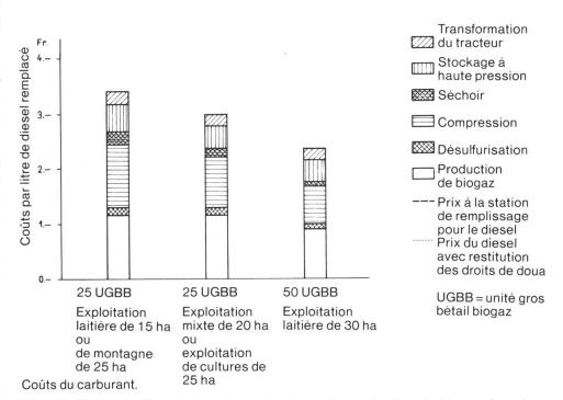
Fig. 12: Coûts par litre de diesel remplacé pour la production de biogaz, la prépration et le stockage du carburant, ainsi que la transformation du tracteur, calculées pour plusieurs exploitations.
