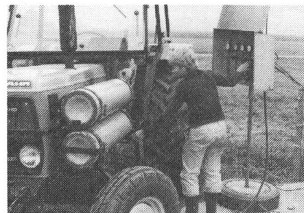
Fig. 6: Remplissage du tracteur avec du biogaz provenant de la réserve de gaz sous pression stationnaire à la station de remplissage.
