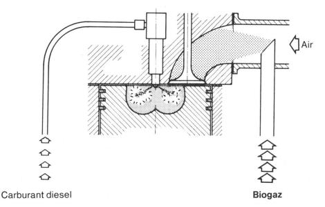
Fig. 2: Dans le moteur à injection pilote, le mélange air-biogaz est enflammé grâce à une petite quantité de carburant diesel.
