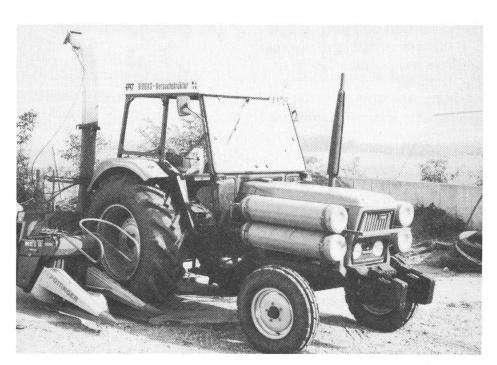
Fig. 1: Le tracteur expérimental transformé pour les fonctionnement au biogaz.
