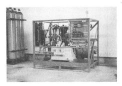
Fig. 5: Unité de compression avec séchoir pour la compression de 5 m³/h de biogaz à raison de 200 bar.
