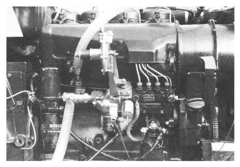
Fig. 3: Parties de construction du régulateur de la pompe à injection pour le réglage simultané du carburant d'allumage et de l'apport de gaz.
