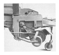
Dorénavant, toutes les autochargeuses et remorques autochargeuses automatiques équipées d'un agrégat Quadro ou de ratelage seront munies d'un nouveau système de relevage du pick-up: 2 vérins hydrauliques – sans câble. Cette technique agit directement et ne subit, simultanément, que peu d'usure.
