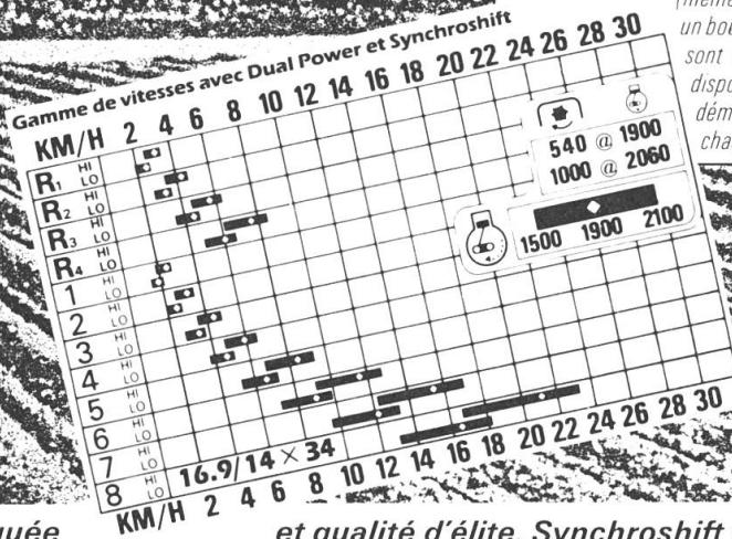
Avec Ford, vous exploitez au mieux la puissance de votre tracteur; le nouveau et pratique schéma en H facilite les opérations; les vitesses rampantes s'enclenchent (même en marche) par pression sur un bouton; les 8, 12, 16 ou 24 rapports sont idéalement étagés. Bref, vous disposez en permanence de la démultiplication optimale pour chaque travail!
