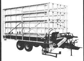
Nouveau système, chargement et déchargement rapide jusqu'à 150 balles. Essieu tandem – traction facile. Exempt de tout dérangement; manœuvres et opérations simples depuis le siège du tracteur.
