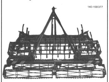
Largeur de travail: 3,35 m à 4,60 m. Avec les petits tracteurs, vous pouvez travailler replié (2,20 m à 2,87 m). Repliement manuel ou hydraulique.
