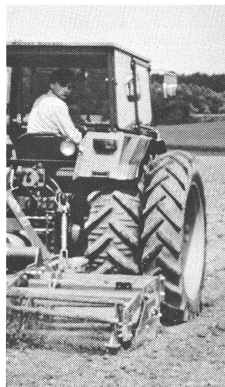
Il est indispensable d'utiliser dès que possible des roues jumelées ou d'adhérence. Etant donné que bien des roues frontales sont trop petites – surtout pour les tracteurs à 2 roues motrices –, les constructeurs devraient faire un effort. (trad. cs)
