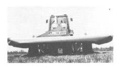
peut être livrée avec 1000/740/540 t/min., rotation à droite ou à gauche.
