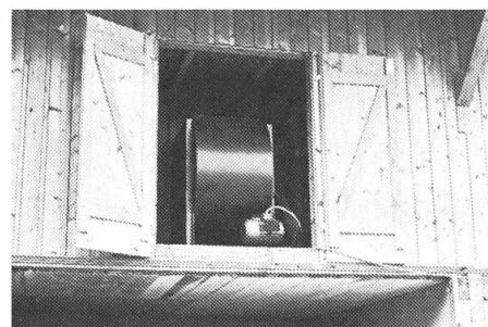
*L'installation de postsséchage en grange doit également être accordée à la quantité de fourrage récolté par jour. Son efficacité dépend essentiellement de la surface de base. Une ventilation à chaud, un capteur solaire ou un taux de flux d'air supérieur ne parviennent pas à compenser entièrement l'effet d'une surface de base insuffisante.*
