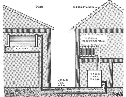
Fig. 2: pompe à chaleur avec absorbeur dans une étable.
