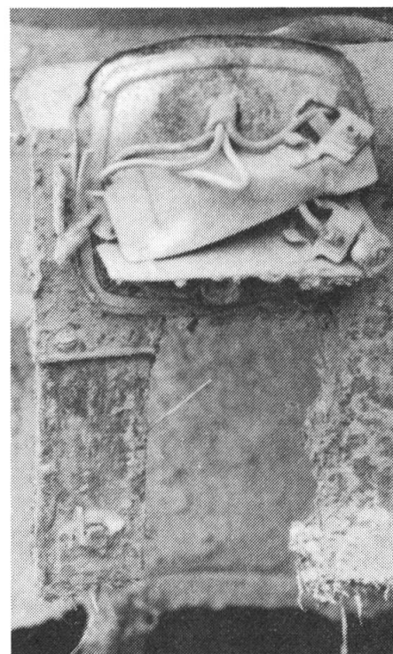
Eclairage non-admis: le feu a été endommagé et le catadioptre arrière triangulaire a été arraché.
