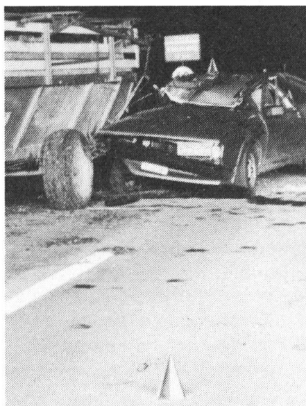
Tamponnement de véhicules étant donné l'éclairage insuffisant de la remorque auto-chargeuse.
