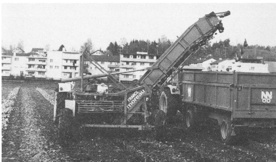
Fig. 4c: Système à trois phases: chargeuse, et transbordement des betteraves sur char roulant en parallèle.
