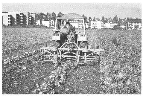
Fig. 4b: Système à trois phases: arracheuse.
