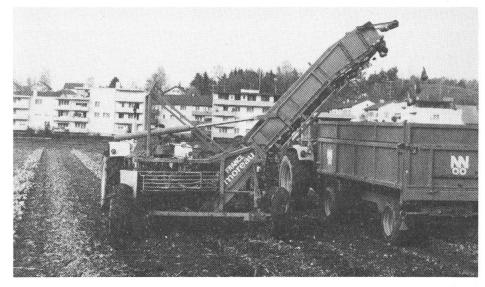
Fig. 4c: Système à trois phases: chargeuse, et transbordement des betteraves sur char roulant en parallèle.
