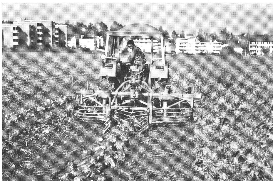
Fig. 4b: Système à trois phases: arracheuse.
