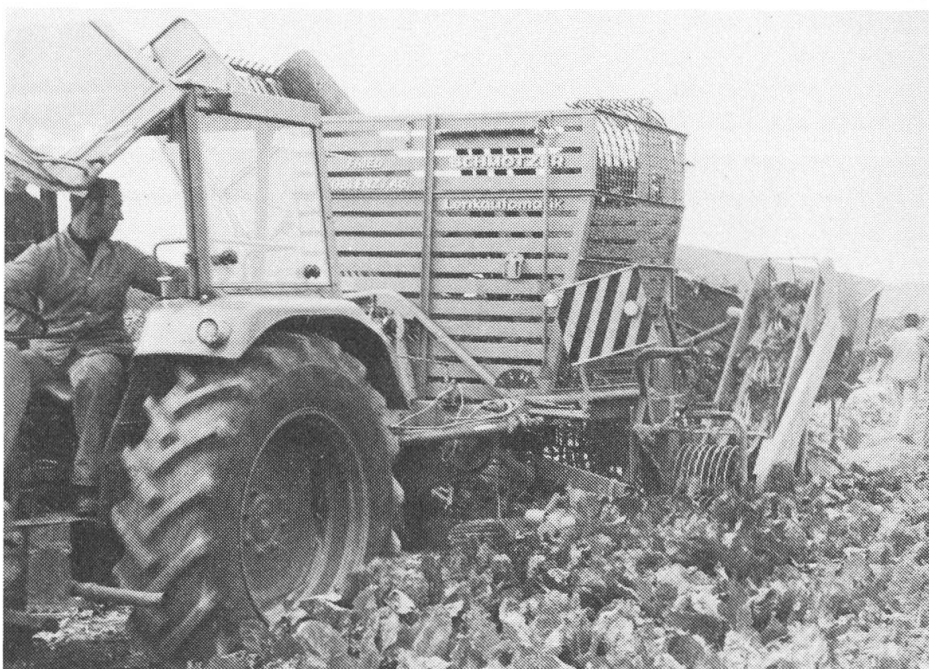
Fig. 1: Récolteuse combinée, tractée, à un rang.
