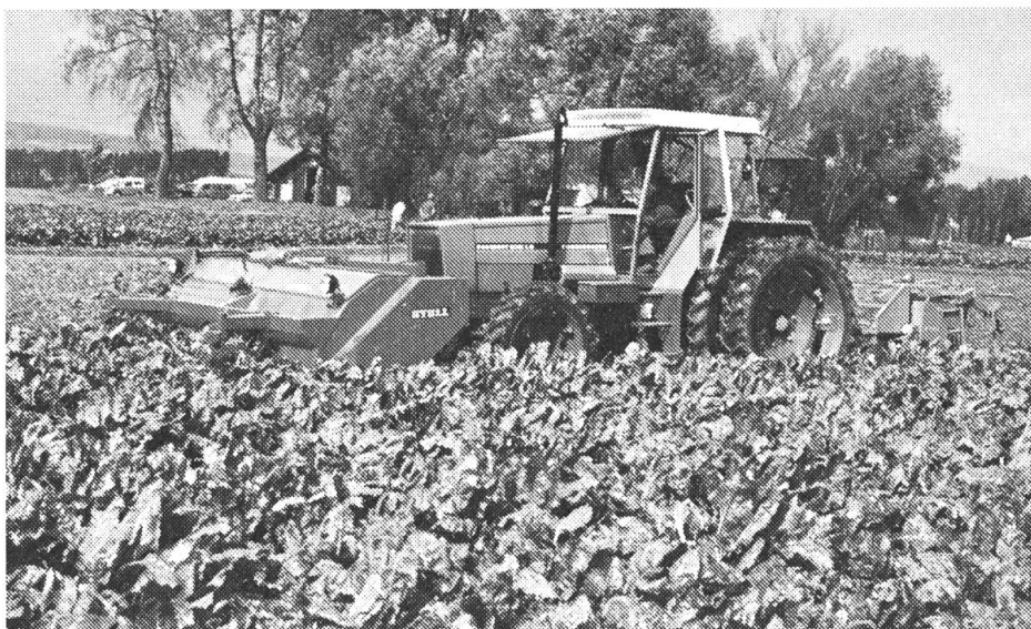
Fig. 3: Système à deux phases: décolleteuse frontale et arracheuse montée à l'arrière (chargeuse voir illustration 4c).
