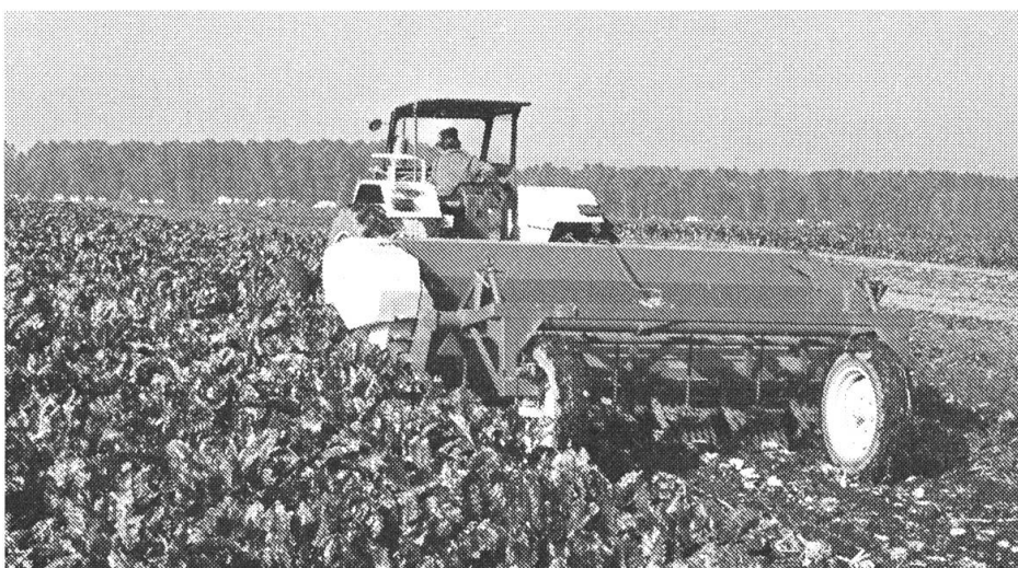
Fig. 4a: Système à trois phases: décolleteuse.
