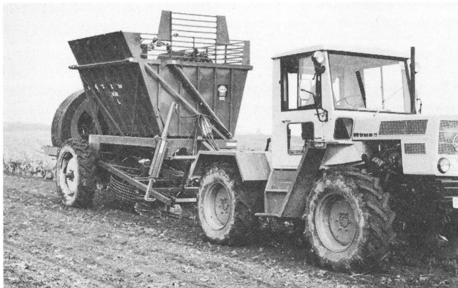
F. 2b: Système à deux phases: trémie-chargeuse, tractée.
