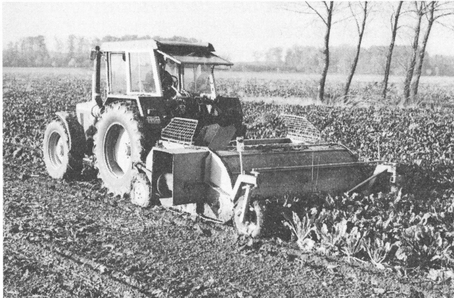
Fig. 2a: Système à deux phases: décolleteuse-arracheuse, poussée par un tracteur qui roule en marche arrière.
