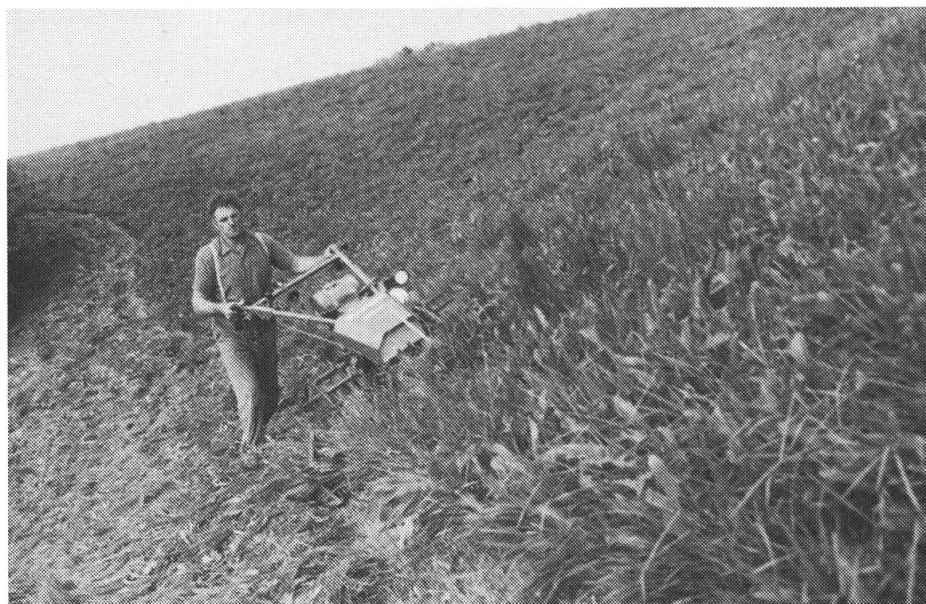
Fig. 5: Avec la faucheuse de montagne, il est possible de faucher jusqu'à 85 % de pente, tandis que toutes les autres machines de récolte atteignent leur limite à 60–65 % max.
