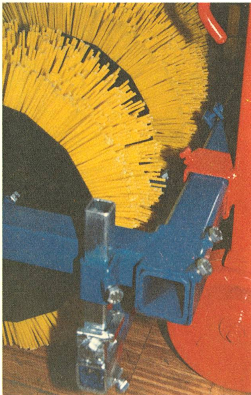
Nouvelle technique dans la lutte contre les mauvaises herbes: Brosse hacheuse pour cultures en rangs.
