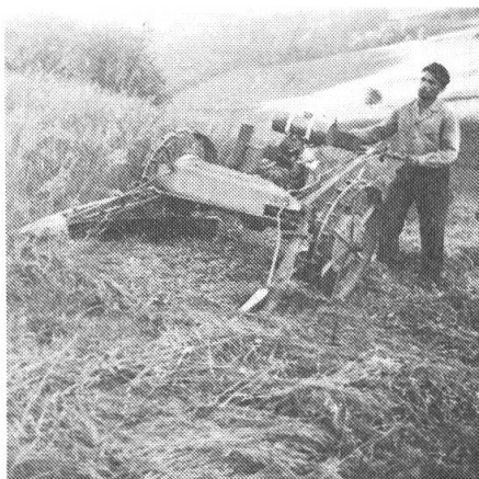
Des motofaucheuses à essieux à portique (passage aisé de l'herbe coupée) étaient très prisées pendant les années de sécheresse 1947 et 1949. Peu après, elles ont cependant été supplantées par des types compacts à entraînement moyen (dispositif aditionnel pour fourrage vert.)
