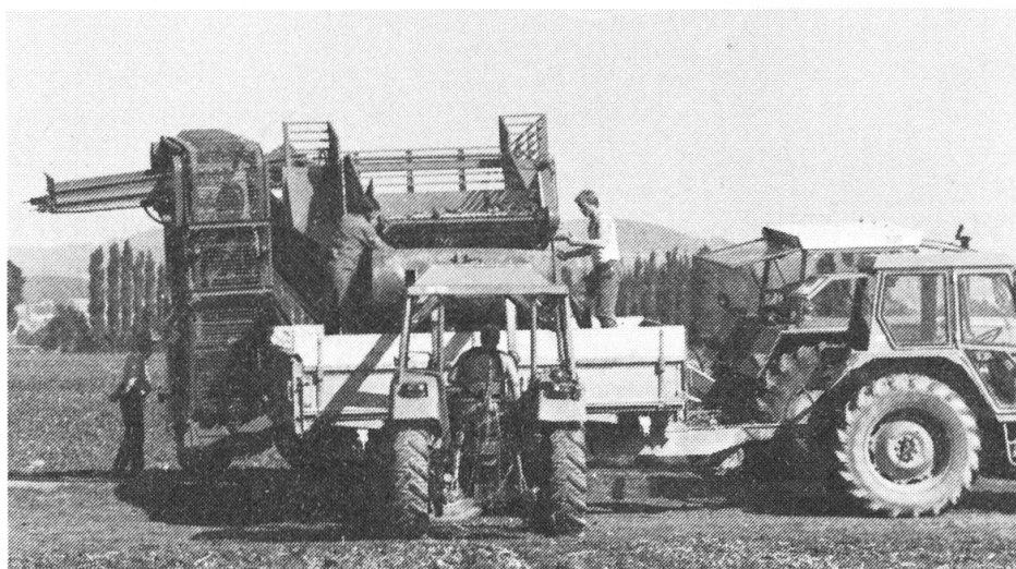
Fig. 1: Prélèvement d'échantillon sur une trémie-chargeuse en cours de test.
