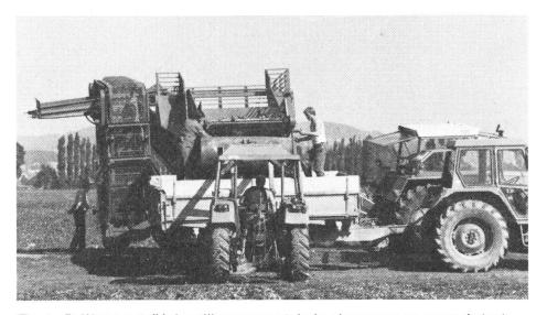
Fig. 1: Prélèvement d'échantillon sur une trémie-chargeuse en cours de test.
