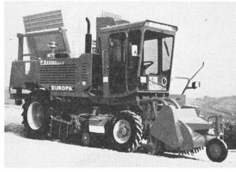
Fig. 6: Nouvelles récolteuses combinées à un et deux rangs automotrices: a) Gam-Guaresi, b) Barigelli Europa I 4 RM (décolletage par battes ou fléaux).
