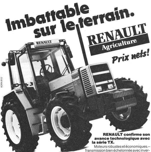
seur synchronisé à 12 rapports AV/AR. – Pont AV moteur axial à transmission directe intégrée, avec «Blocamatic». – Relevage hydraulique «Tracto-control» efficace et sensible. – Direction hydrostatique. – Freins à disques. – Cabine de sécurité basculable, insonorisée, avec chauffage et ventilation, visibilité panoramique. – Siège ergonomique. – **Options:** Relevage et prise de force AV, climatisation etc.
