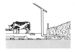
Le transport du fumier dans le canal s'effectue, comme habituellement, avec la barre de traction qui le fait avancer dans le canal. La nouveauté est l'empilage du fumier. Celui-ci passe dans une presse de 2 mètres de long qui draine dans une cuve située sous le tas de fumier et ensuite le pousse vers le haut.
