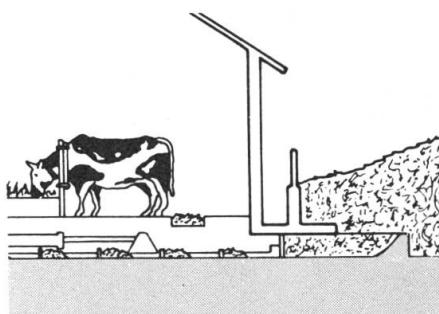
Le transport du fumier dans le canal s'effectue, comme habituellement, avec la barre de traction qui le fait avancer dans le canal. La nouveauté est l'empilage du fumier. Celui-ci passe dans une presse de 2 mètres de long qui draine dans une cuve située sous le tas de fumier et ensuite le pousse vers le haut. Le passage entre le tas de fumier et l'étable est fermé, de ce fait exempt de courant d'air.
