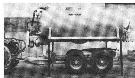
Grâce à un système à prisme qui travaille très précisément, le problème du changement facile et rapide des agrégats a été résolu d'une manière idéale. Les possibilités de montage de citerne, benne basculante etc. sont presque illimitées, car les six fonctions de commande
