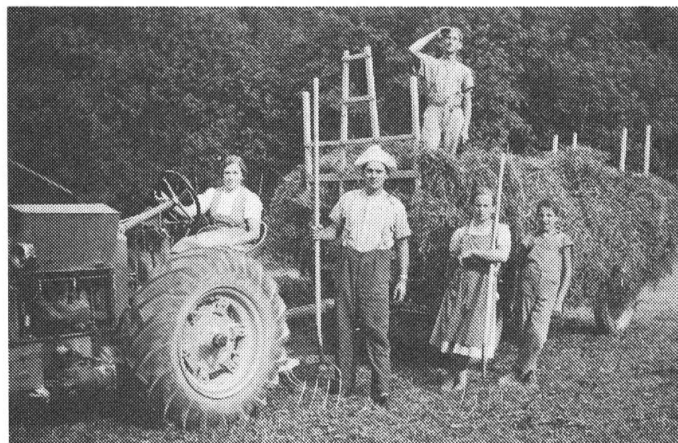
Tracteur Hürlimann à un cylindre véhicule av. roues à bandes de fer. (1930) Photo: J. Krüsi-Heller, Sulgen TG
