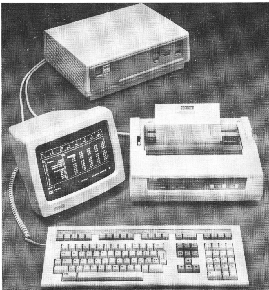
Le Personal Computer (ordinateur) «Rainbow 100» consiste en un écran, un clavier, une imprimante (à droite et à mi-hauteur de l'illustration) et une mémoire principale à mécanisme d'entraînement à disque souple.
