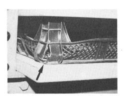
Fig. 9b): Un point de cassure typique (flèche) à une charge de 2250 kg.
