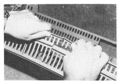
Fig. 10): Un modèle de clayette (F, vert) n'a pas résisté aux dommages causés par les intempéries. Après un entreposage en plein air de 12 mois, même les parties portantes se cassaient d'une simple pression de la main.
