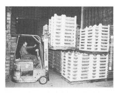
Fig. 3: La palettisation offre également des avantages la, où les unités de clayettes doivent être transbordées pour obtenir une température régulière partout.
