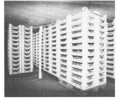
Fig. 2: Seuls les caisses et récipients à dimensions standardisées se prêtent à la palettisation (60 × 40 cm).
