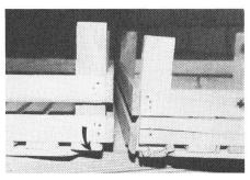
Fig. 11: Un angle d'une caisse en bois enfoncé (à droite). En plaçant un support en dessous de la caisse inférieure, (flèche), la solidité dans l'emboîtement pourrait être fortement améliorée.
