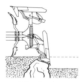
NON-STOP avec force de déclenchement EN DIMINUANT. Système à ressorts,
