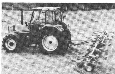
Lors de la conception des nouveaux *Deutz-Fahr* DX-3, les constructeurs ont porté leur concentration sur une technique économique et une grande puissance dans une forme compacte. Ces modèles sont dotés d'une traction 2-4-roues-motrices, d'une puissance nominale entre 46 et 70 CV. La boîte Dual-Split (demi-vitesse) permet un échelonnage de la puissance pour toutes les utilisations. Les modèles à traction sur les
