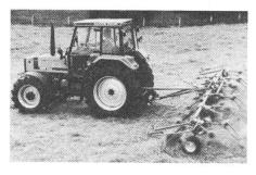
Lors de la conception des nouveaux *Deutz-Fahr* DX-3, les constructeurs ont porté leur concentration sur une technique économique et une grande puissance dans une forme compacte. Ces modèles sont dotés d'une traction 2–4-roues-motrices, d'une puissance nominale entre 46 et 70 CV. La boîte Dual-Split (demivitesse) permet un échelonnage de la puissance pour toutes les utilisations. Les modèles à traction sur les
