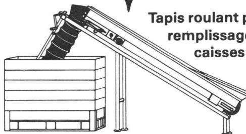
Tapis roulant pour remplissage de caisses paloxes
