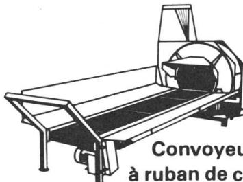
Convoyeur pour soufflerie à ruban de caoutchouc
