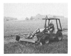
Tracteur faucheur MT 250 – la machine polyvalente munie d'une barre de coupe à bande andaineuse.
