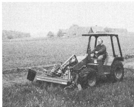
Tracteur faucheuse MT 250 – la machine polyvalente munie d'une barre de coupe à bande andaineuse.
