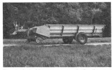
Fig. 1: Autochargeuse surbaissée TL-200.
