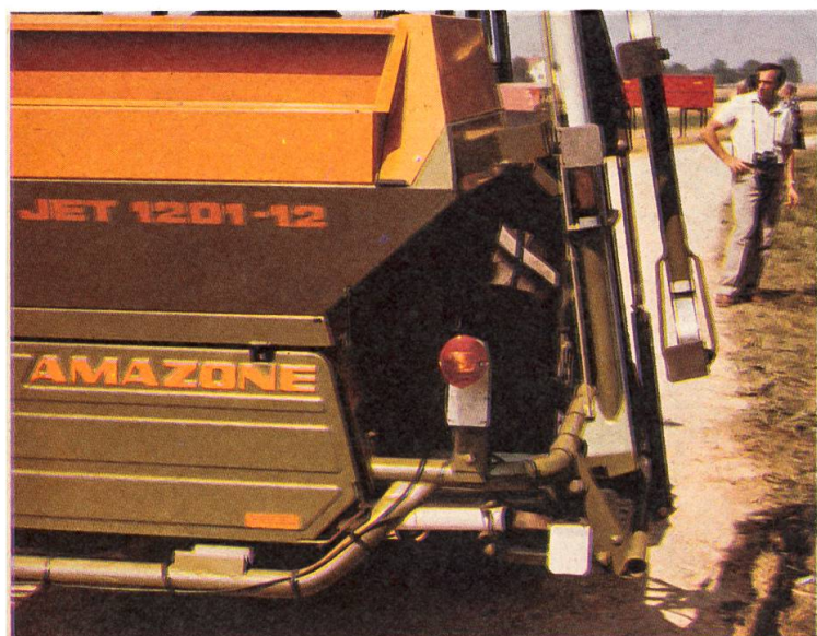
Fig. 4: Les grands distributeurs d'engrais cachent souvent l'installation d'éclairage et de clignoteurs des tracteurs. A cette fin, un éclairage supplémentaire est prescrit sur toutes les machines portées. Les raies noires et jaunes sur les côtés devraient être appliquées avant la remise de la machine au prochain client.
