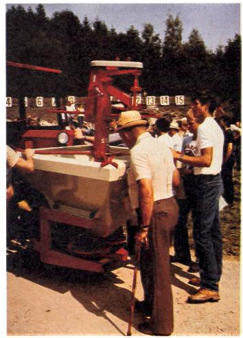
Fig. 4: Les grands distributeurs d'engrais cachent souvent l'installation d'éclairage et de clignoteurs des tracteurs. A cette fin, un éclairage supplémentaire est prescrit sur toutes les machines portées. Les raies noires et jaunes sur les côtés devraient être appliquées avant la remise de la machine au prochain client.
