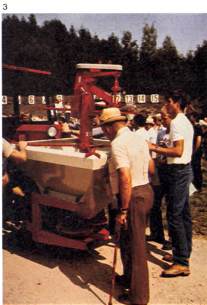
Fig. 3: Toutes les tranches d'âge admirent la technique moderne. Avec ce distributeur d'engrais, équipé d'un dispositif pour fumure tardive, les engrais azotés peuvent être appliqués sans problèmes jusqu'après l'épiaison.
