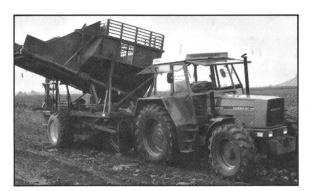
V 200 décolleteuse-arracheuse-chargeuse de betteraves, traînée, à deux rangs.
