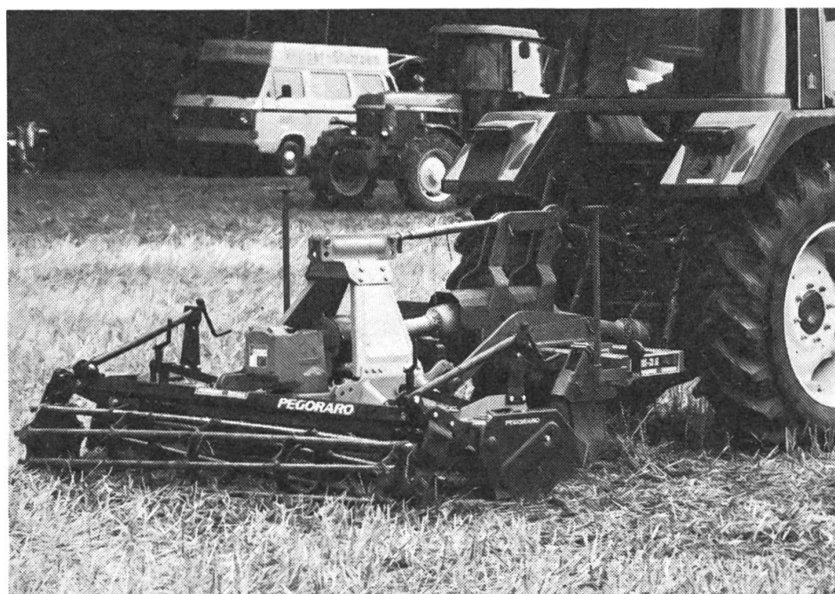
Fig. 1: Combinaison herse rotative Althaus-Pegoraro/semoir Aebi-Roger.
