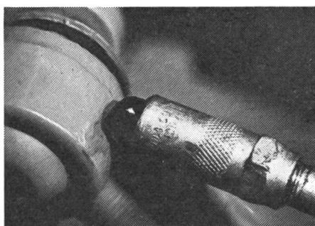
Fig. 4: Il est aussi grave d'incorporer de la graisse malpropre que l'absence de toute graisse. En premier lieu, il s'agit donc, d'enlever avec un torchon toute trace de graisse.
