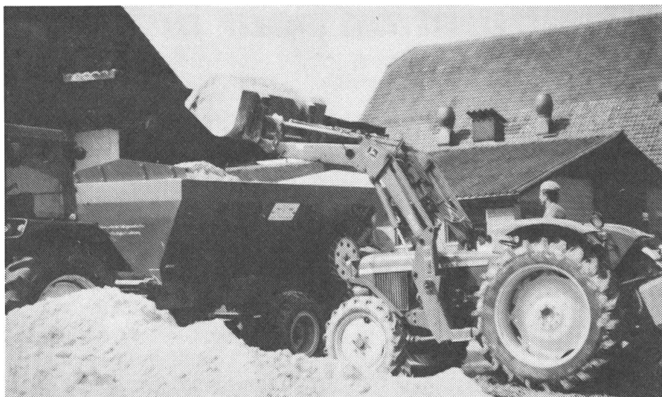
Fig. 2: La boue de curage déshydratée peut être stockée pendant des périodes assez longues. Son chargement sur le distributeur a lieu à l'aide d'un chargeur frontal.
