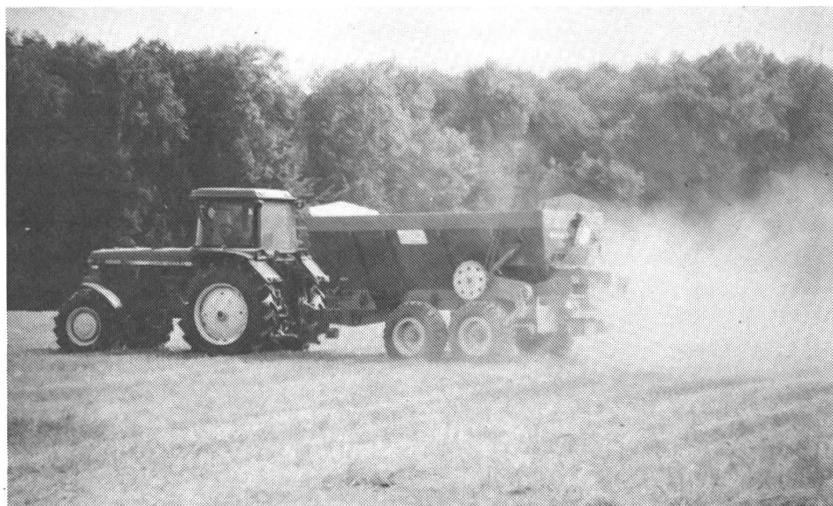
Fig. 1: L'application de la boue de curage déshydratée a lieu au moyen d'un distributeur à grand travail remorqué par un tracteur.
