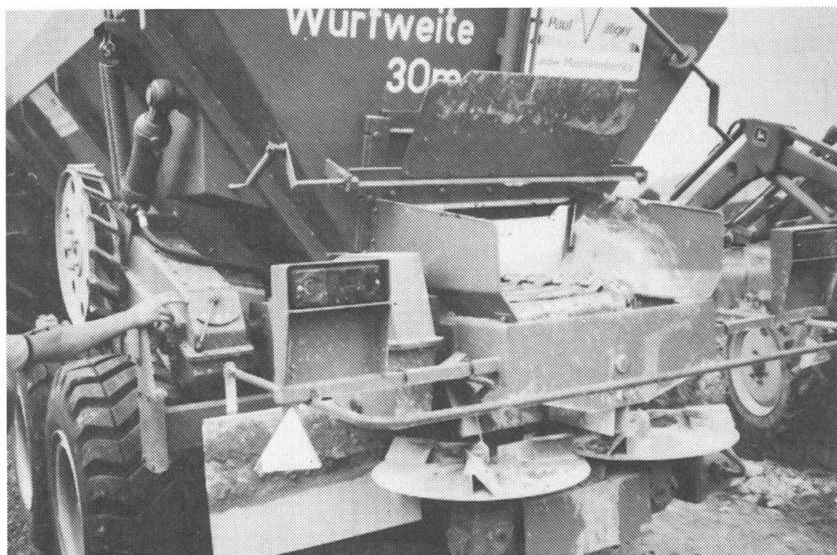
Fig. 3: La boue de curage épandable est transférée sur le dispositif distributeur à deux disques au moyen d'un convoyeur à chaîne asservi à l'avancement.
