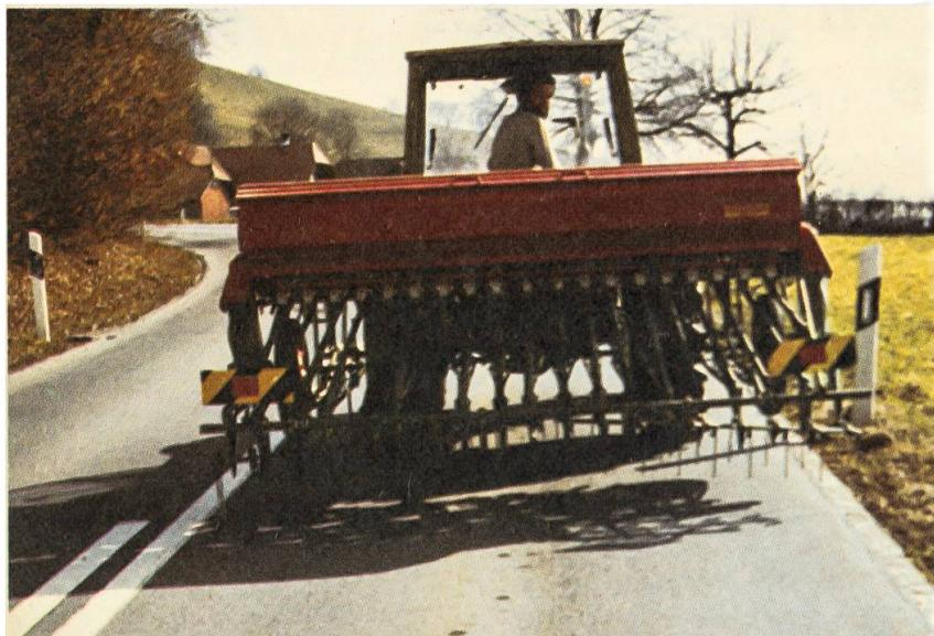
*Ce semoir à la volée portée n'est que partiellement équipé selon les règles. La peinture noire et jaune et les catadioptrès intégrés attire l'attention sur la largeur exceptionnelle de la machine. Mais vu que cette machine recouvre l'installation de clignoteurs arrière du tracteur, il s'agit d'apposer de nuit et par mauvaise visibilité un éclairage de remplacement correspondant. Il est préférable de monter celui-ci à demeure sur l'appareil porté.*
