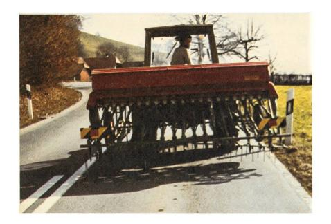
Ce semoir à la volée portée n'est que partiellement équipé selon les règles. La peinture noire et jaune et les catadioptres intégrés attire l'attention sur la largeur exceptionnelle de la machine. Mais vu que cette machine recouvre l'installation de clignoteurs arrière du tracteur, il s'agit d'apposer de nuit et par mauvaise visibilité un éclairage de remplacement correspondant. Il est préférable de monter celui-ci à demeure sur l'appareil porté.
