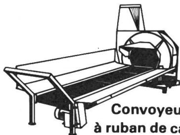
Convoyeur pour soufflerie à ruban de caoutchouc
