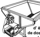
Trémie de stockage avec tapis roulant d' évacuation de dosage et variateur (1,5 t)
