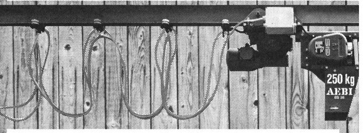
Elle arrache 250 kg, prélève jusqu'à 130 kg de foin par griffe, avance et recule à 40 m/min., monte et descend à 16 m/min. Elle atteint tous les recoins, ne craint aucune montée ou descente jusqu'à 15° et possède un engrenage autofreinant. Toutes les fonctions sont télécommandées depuis le tas de foin et la griffe se décharge en hauteur ou au sol.
