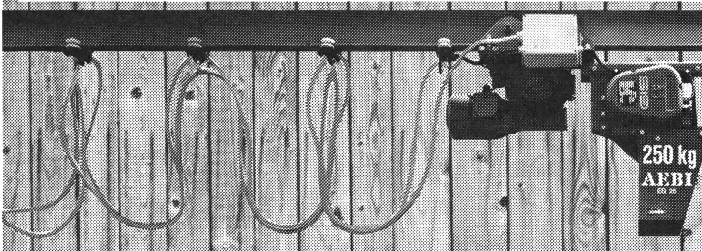
Elle arrache 250 kg, prélève jusqu'à 130 kg de foin par griffe, avance et recule à 40 m/min., monte et descend à 16 m/min. Elle atteint tous les recoins, ne craint aucune montée ou descente jusqu'à 15° et possède un engrenage autofreinant. Toutes les fonctions sont télécommandées depuis le tas de foin et la griffe se décharge en hauteur ou au sol.
