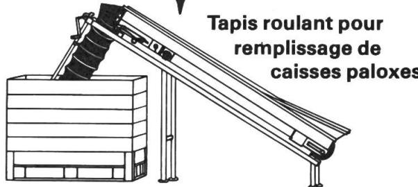
Tapis roulant pour remplissage de caisses paloxes
