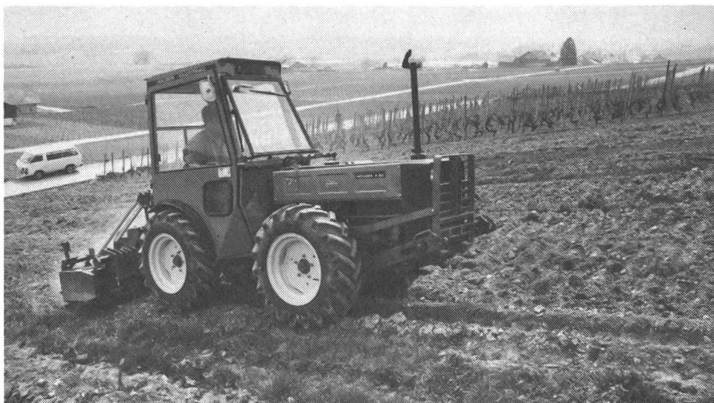
Fig. 2: Les tracteurs à chasis articulé sont surtout appréciés en viticulture grâce à leur maniabilité. Ils nécessitent cependant des tournières plates.
