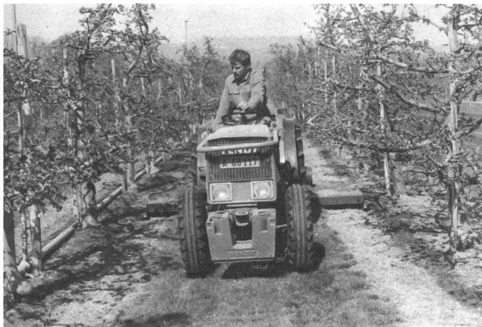
Fig. 1: Les tracteurs étroits construits de manière compacte, avec gardes-boue en caoutchouc qui couvrent les pneus si possible jusqu'aux bords extérieurs, permettent aux branches des arbres fruitiers de s'étendre latéralement au maximum et garantissent une exploitation aisée des cultures.
